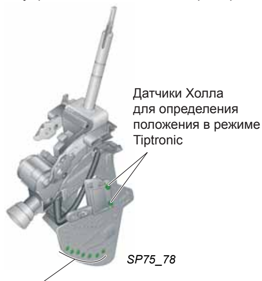
Датчики Холла для определения положения рычага селектора
