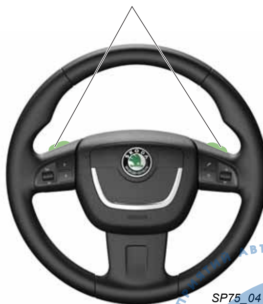
Переключатели Tiptronic на рулевом колесе E389
