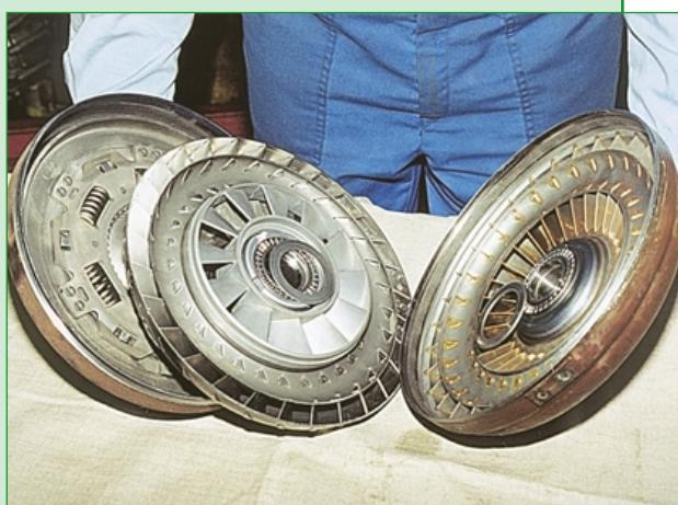
Вскрытие ГДТ — обязательная операция при ремонте. Заодно имеем возможность заглянуть вовнутрь. В правой руке — часть корпуса гидротрансформатора с блокирующим сцеплением. Посередине — турбинное колесо с реактором на обгонной муфте.
