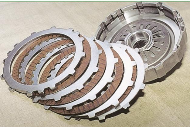
Удивительно, но факт: одни из самых ответственных деталей этого исключительно «металлического» агрегата, каким является многодисковое сцепление, изготавливаются из бумаги. Накладки из бумажной композиции обеспечивают необходимую силу трения между дисками.
