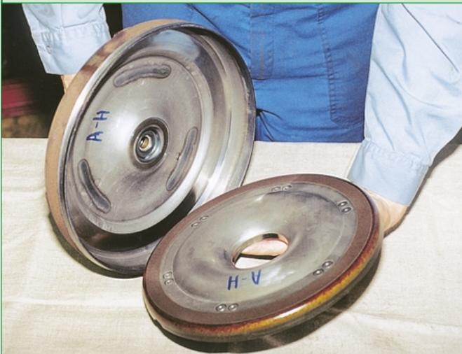
(она проявляется незначительным увеличением расхода топлива). Гораздо серьезнее могут быть последствия этого дефекта, если продукты износа с трансмиссионной жидкостью попадут, например в систему управления коробки.
